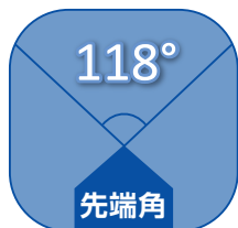
ドリルの先端角 Drill tip angle
